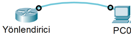
Görsel 3.3: Yönlendiricinin konsol kablosu ile bağlantısı
