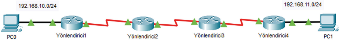
Görsel 5.5: Uzaklık vektörü ile bağlantı durum protokolleri için ağ topolojisi
