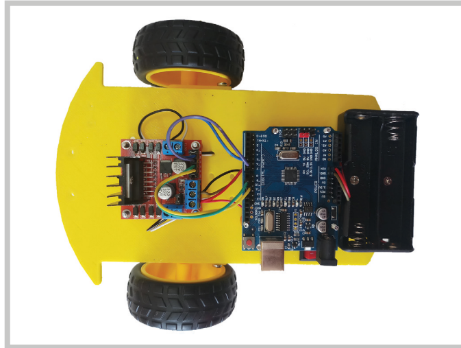
Görsel 3.19: Bileşenlerinin montajı yapılmış eğitsel robotun kablo bağlantıları
