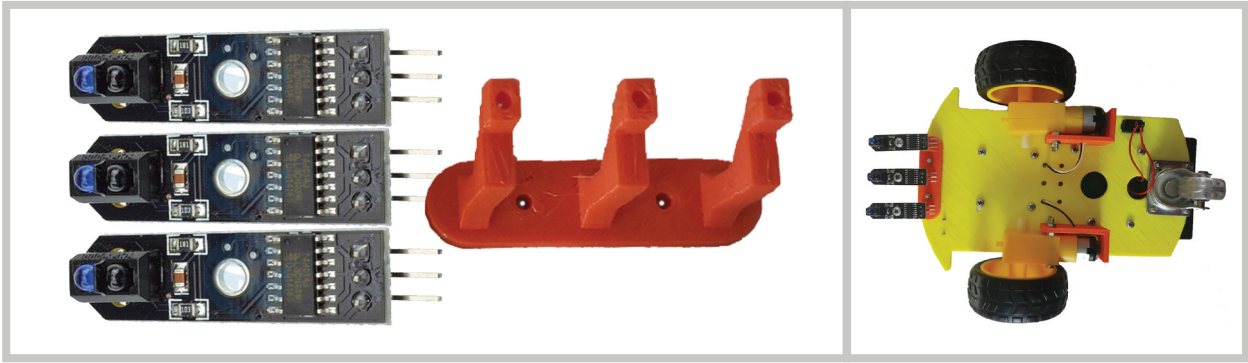
a) Çizgi izleme sensörleri ve montaj aparatı
