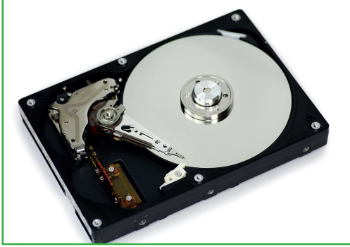
Görsel 3.24: Manyetik diskli sabit sürücü iç yapısı
