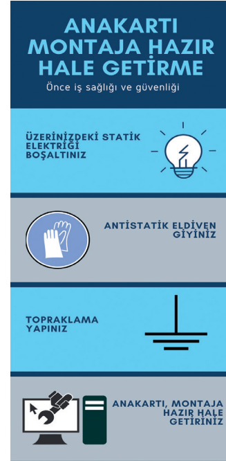
Görsel 3.6: Anakartı montaja hazır hâle getirmek için yapılması gerekenleri belirten bir broşür örneği
